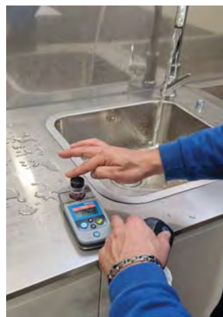
Determinação de Cloro Residual na torneira do consumidor reservatório
